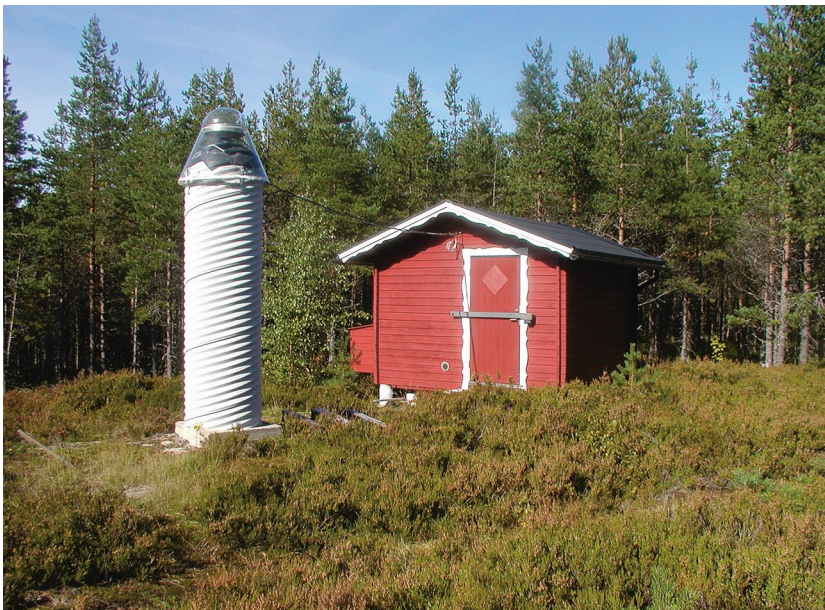
Figur 6-6. Referensstation för satellitpositionering som även används för kontinuerlig registrering av höjden.
