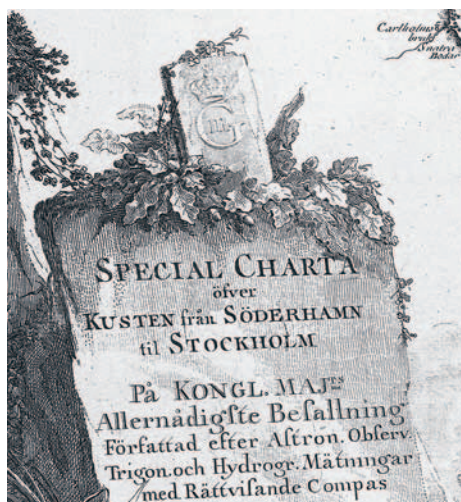
Figur 5-11. Påpekande på sjökortet i figur 5-10 om att det bygger på såväl astronomiska observationer som trigonometriska mätningar, det vill säga triangelmätningar.
