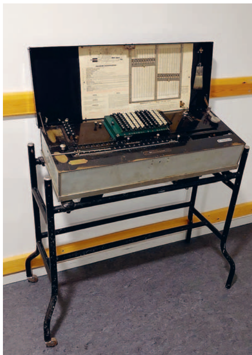
Figur 6-16. Räknemaskin som för första gången kunde multiplicera, använd i trianguleringsberäkningar i början av 1900-talet. Maskinen kunde hantera tal med upp till 10 siffror.
