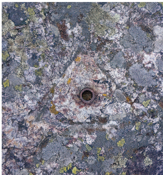
Figur 5-4. Triangelpunkten Väddö kasberg på Upplandskusten ingående i 1700-talets Ålandstriangulering, efter vårdkasens avskaffande markerad med borrhål och triangel i berget för framtida återfinnande.
