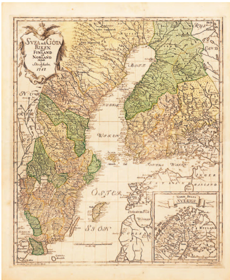
Figur 4-3. Den första kartan över Sverige och Finland (med angränsande delar av Danmark och Norge) grundad även på longituder från månobservationer, utgiven 1747.
